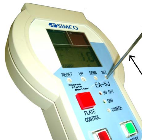
測定条件設定ボタン(SET)の押し方
