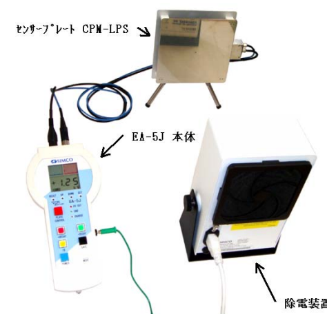
プレートセンサーと除電装置の位置関係
