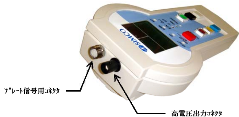
センサープレート接続用コネクタ
